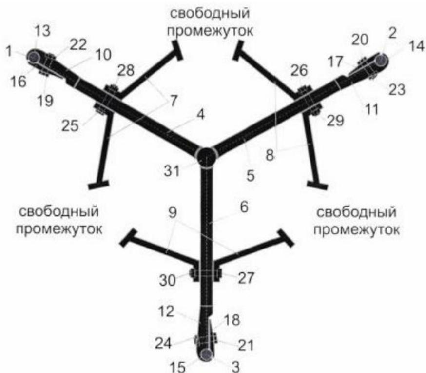
Рисунок 26 - Устройство распорки-гасителя для подавления пляски проводов расщепленной фазы линии электропередачи
